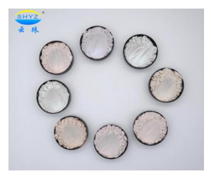
珠光颜料是一种由天然云母制成的新型珍珠光泽颜料,其表面覆盖有金属氧化物。它可以重现天然珍珠、贝壳、珊瑚和金属的光彩和颜色。显微为透明、平无,靠光的折射、反射、透射来显示颜色和光。珠光颜料是无毒、耐高温、光、酸和碱,不自燃,不燃烧,不导电,不迁移,可以满足不同需求的涂料、塑料、油墨、皮革、印染、橡胶、纸张、化妆品等行业,这些行业的产品有一个更辉煌的外观和明亮的光线。珠光颜料越透明,珠光颜料越漂亮,珠光颜料或染料越透明。但应避免与不透明的成分或有较强遮盖物的颜料混合,如二氧化钛、氧化铁等,以免影响珠光效果。
